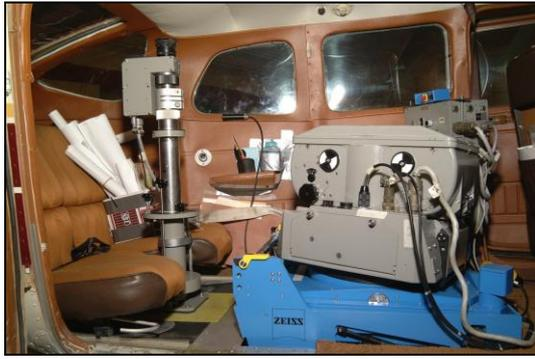
Figura VI.31a – Câmara aérea Zeiss RMK
