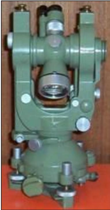
Figura IV.05 – Teodolito prismático
