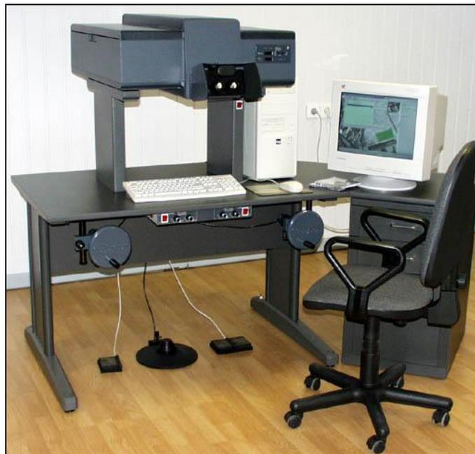
Figura VI.50 – Estação Fotogramétrica Analítica “Stereoanagraph” da GeoSystem
