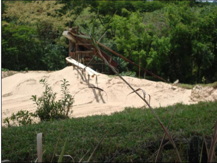
Figura II.10b – Área de armazenamento e eliminação do excesso de umidade da areia extraída do rio
