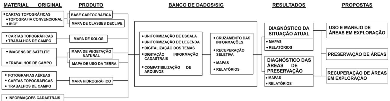
Figura IX.06 – Exemplo de um Diagrama de Fluxo de Dados para um projeto ambiental numa bacia hidrográfica
