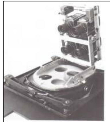
Figura VI.32 – Câmara multibanda no arranjo de quatro câmaras individuais de 70mm, da Spectral Data Corporation
