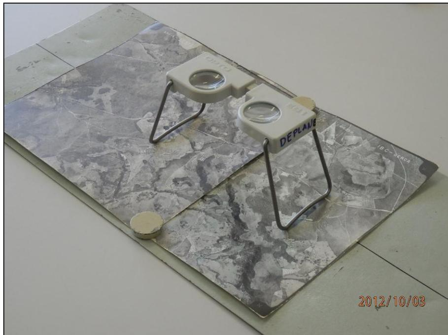
Figura VI.41 – Estereoscópio de bolso
